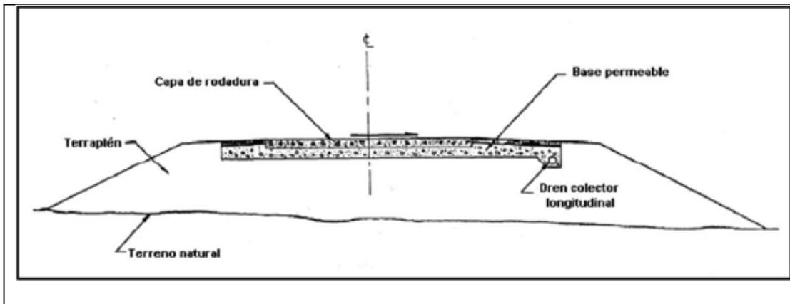
**Figure 7.41 Longitudinal drain scheme**
