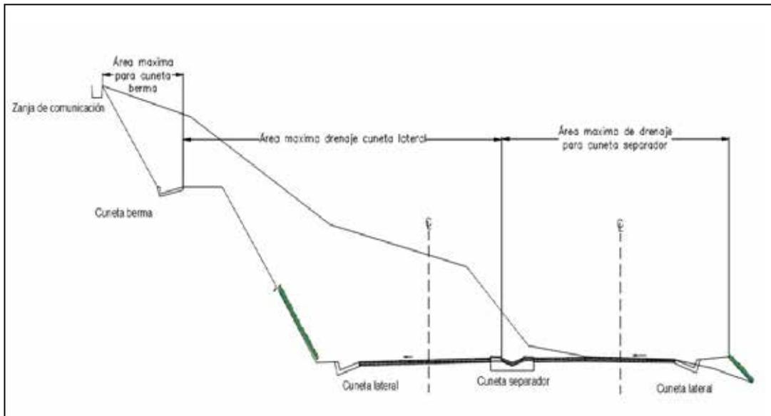
**Figure 7.39 Longitudinal drainage elements**
