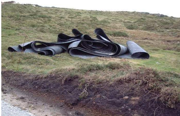
Figura 86 –Detalle de manta de goma utilizada en las voladuras
