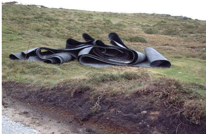
Figura 71 –Detalle de manta de goma utilizada en las voladuras
