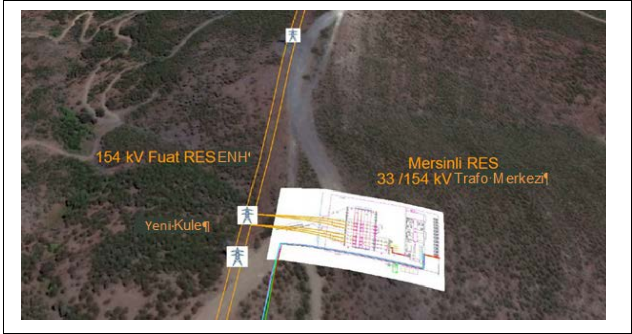
Şekil 3–2. Mersinli RES Projesi Trafo Merkezi ve ENH bağlantısı
