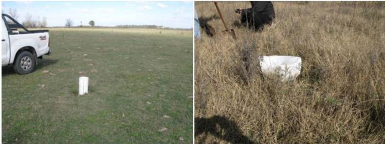
Figura 55- Piezómetros en recintos Tramo III, Salado Inferior
