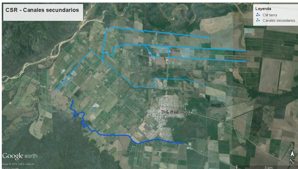
Figura N°106. Esquema obras de distribución. Canales secundarios excavados en tierra. Colonia Santa Rosa. Año 2015
