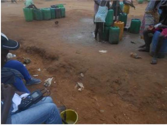
Figure IV. 2 a: mesure in situ de paramètres physiques du forage d'Adonkoi à l'aide d'un multiparamètre
