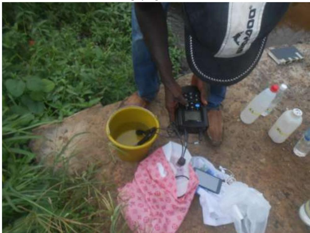
Mesure de paramètres physiques sur une rivière à l'Ouest de la rivière Gbangbo
