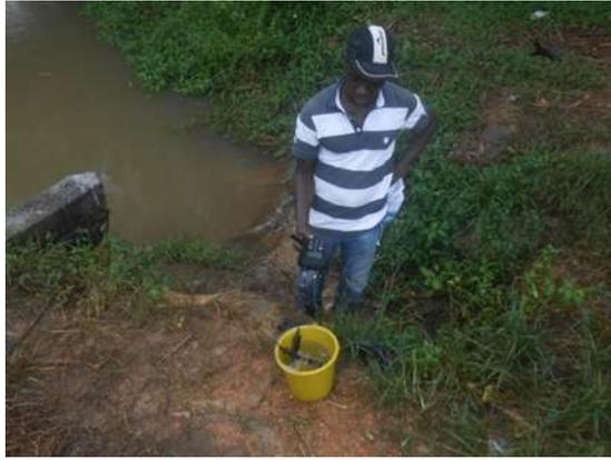
Figure IV. 2 b: mesure in situ de paramètres physiques sur un affluent de la rivière Niéké à l'aide d'un multiparamètre
