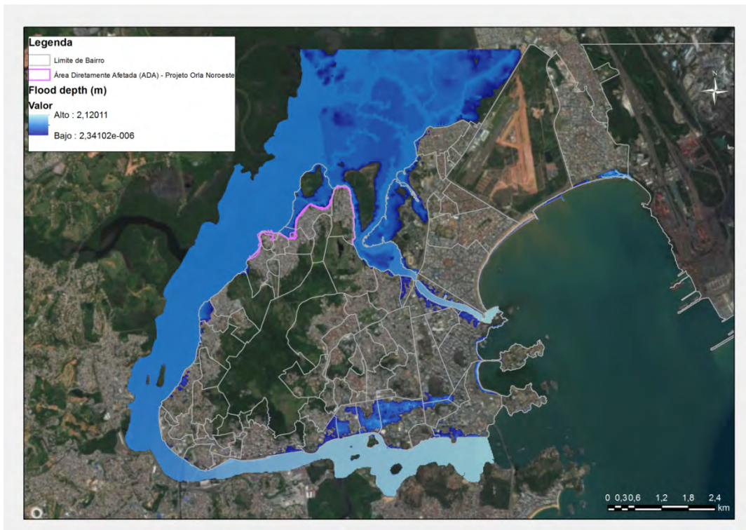
Figura 5.1.3.m Inundação (profundidade) - Aumento do nível do mar de 0,20 m – Tempo de Retorno de 50 anos
