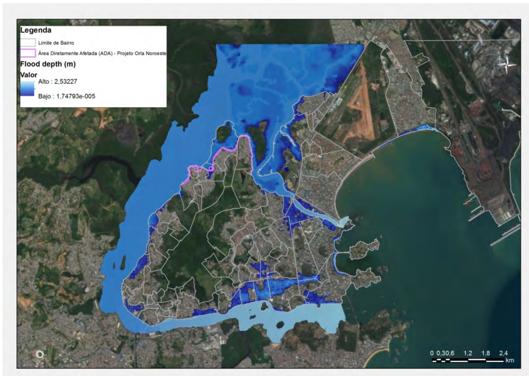
Figura 5.1.3.s Inundação (profundidade) - Aumento do nível do mar de 0,50 m – Tempo de Retorno de 50 anos
