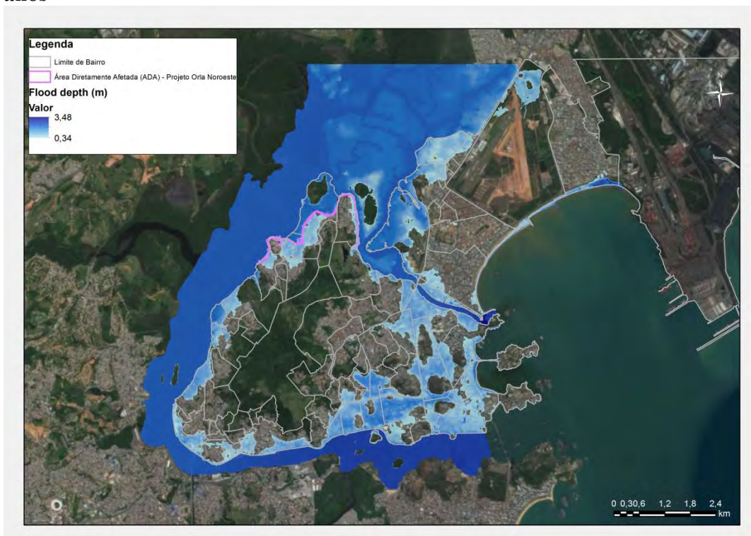
Figura 5.1.3.aa Inundação (profundidade) - Aumento do nível do mar de 1 m – Tempo de Retorno de 200 anos
