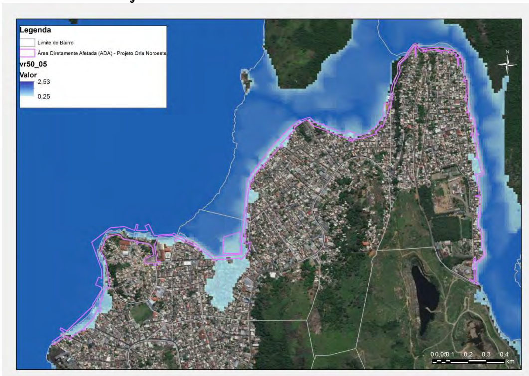
Figura 5.1.3.t Inundação (profundidade) - Aumento do nível do mar de 0,20 m – Tempo de Retorno de 50 anos - ADA do Projeto Orla Noroeste
