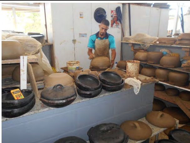
Foto 15: Panelleiro lixando panela para alisar e homogeneizar sua superfície antes da queima do material.
