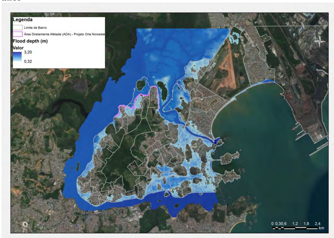
Figura 5.1.3.y Inundação (profundidade) - Aumento do nível do mar de 1 m – Tempo de Retorno de 50 anos
