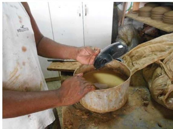
**Foto 20:** Espátula de cuiá utilizada para moldar a panela de barro.
