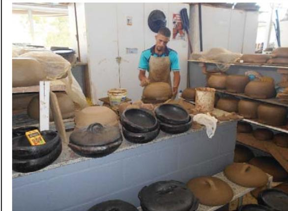
**Foto 15:** Paneleiro lixando panela para alisar e homogeneizar sua superfície antes da queima do material.
