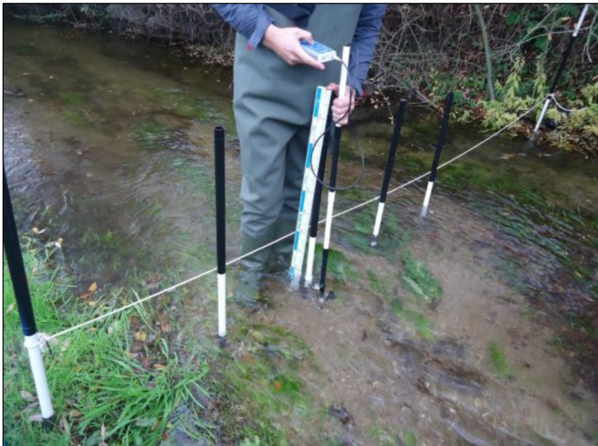
**Figura 6.2 - Secção transversal. Medições dos parâmetros profundidade e velocidade média ponto a ponto, adaptado de Lencastre e Franco (1984, p. 252)**
