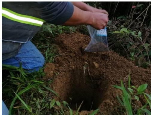
Fotografía 17. Toma de muestra para monitoreo de suelo en el sector Bellavista-Progreso.
