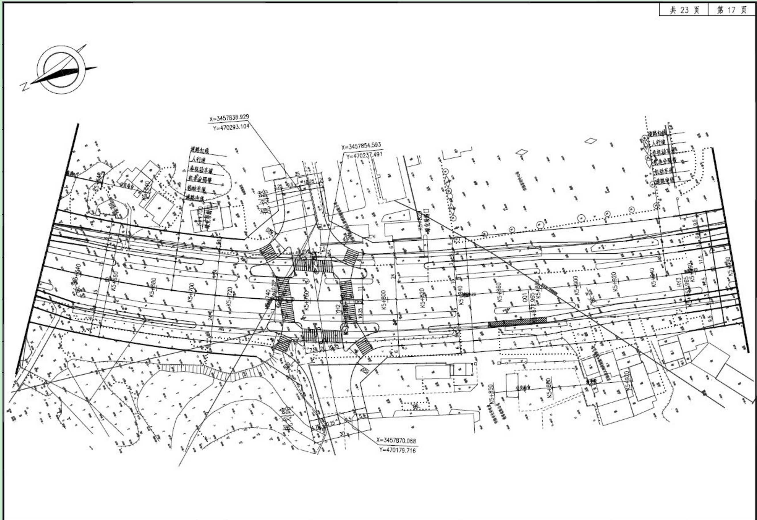
附图 3-1-17 世行贷款武汉城市圈交通一体化示范项目-孝感安陆市城市交通基础设施子项——太白大道道路平面设计图
