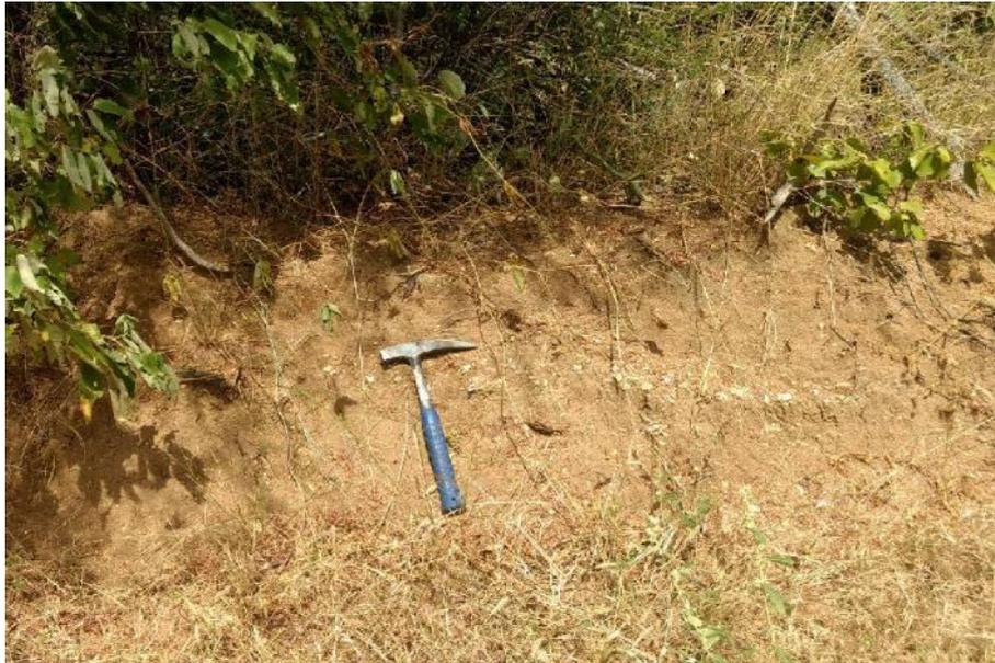
**Figura 8.2.2-o:** Solo do tipo Neossolo Flúvico (Solo Aluvionar), arenoso com presença de argila, intercalados com seixos.
