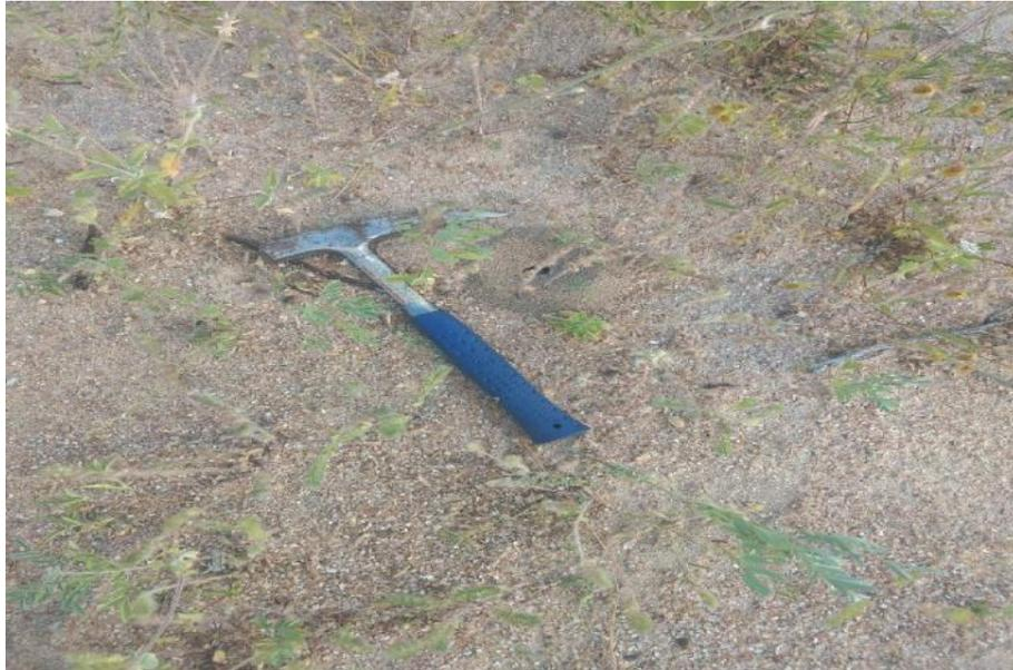
**Figura 8.2.2-m:** Solo Neossolo Regolítico Eutrófico, acinzentado, com pequenos seixos de quartzo e feldspato, anguloso a subanguloso.
