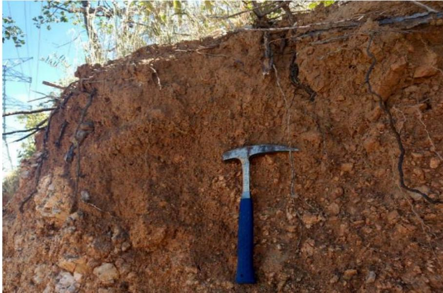
**Figura 8.2.2-g:** Solo Argissolo Vermelho Eutrófico, horizonte B resultando da alteração dos minerais da rocha subjacente.
