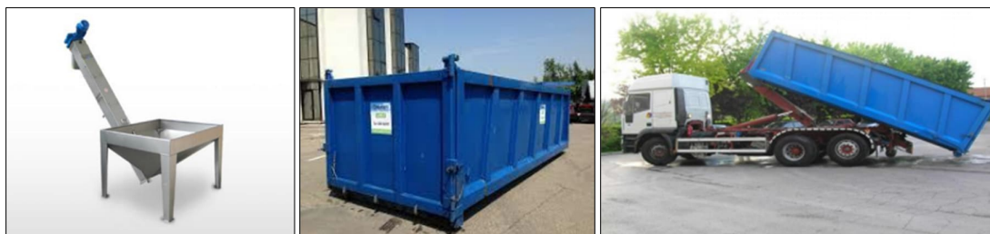
Figura 2.20: Sistema captación y almacenamiento lodos deshidratados
