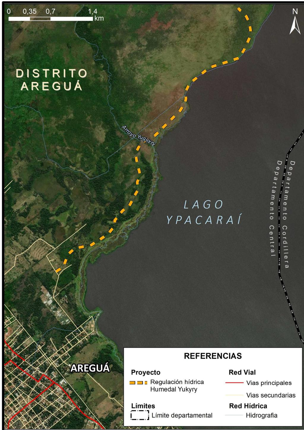
Figura 1.15. Emplazamiento de estructuras de regulación hídrica (naranja)
