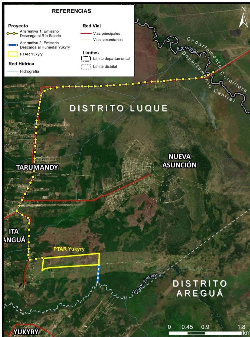
Figura 2.20: Alternativas de Emisarios de Descarga PTAR: Alternativa I: Descarga en el Río Salado (amarillo); Alternativa II: Descarga al Humedal Yukyry (azul y blanco)
