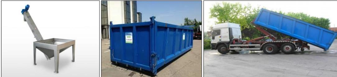
Figura 2.18: Sistema captación y almacenamiento lodos deshidratados
