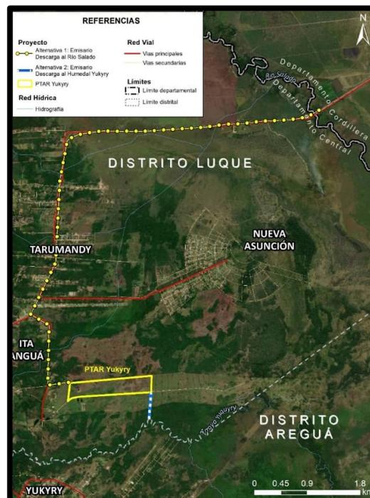
Figura 8.2: Alternativas de Emisarios de Descarga PTAR: Alternativa I: Descarga en el Río Salado (amarillo); Alternativa II: Descarga al Humedal Yukyry (azul y blanco).
