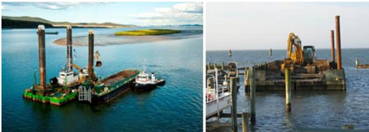
Photographie 15 : A gauche : pelle rétro-caveuse, ici avec navire sablier et remorqueuse ; à droite : pelle mécanique sur barge
