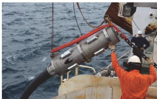
Photographie 11 : Exemple de jonction sous-marine type « dry-mate » (Source : Macartney)
