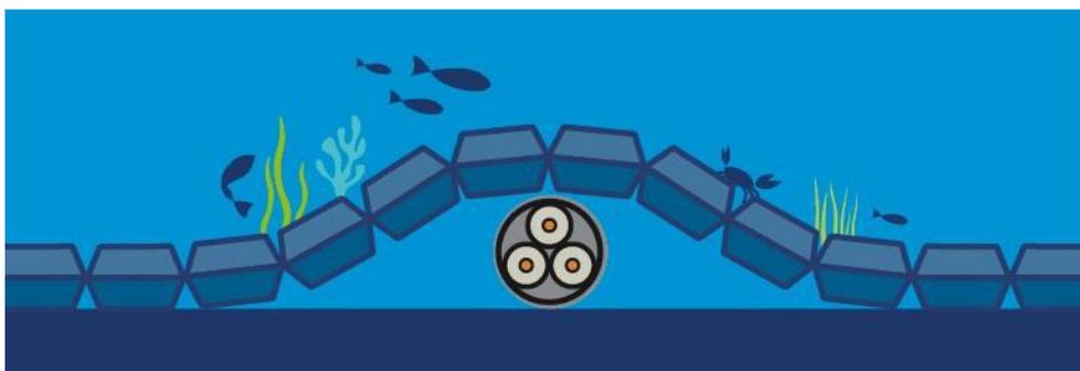
Figure 46 : Le matelas béton (autre protection externe possible) (Source : RTE et BRLi, 2016)
