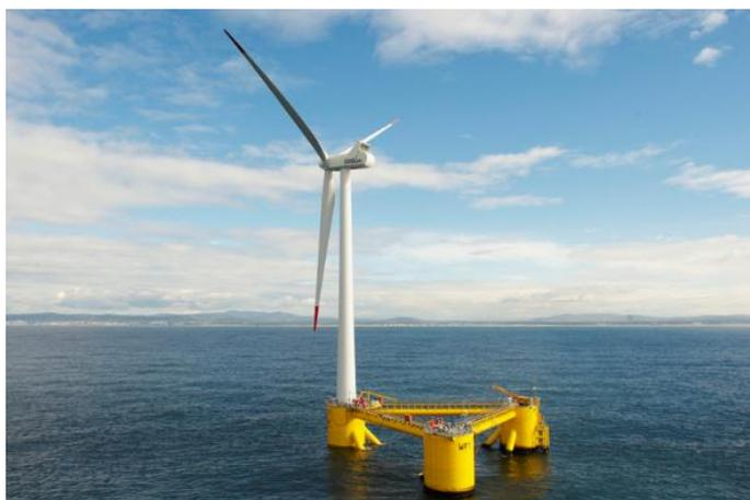
Photographie 1 : Prototype WindFloat 1 (source : PPI)
