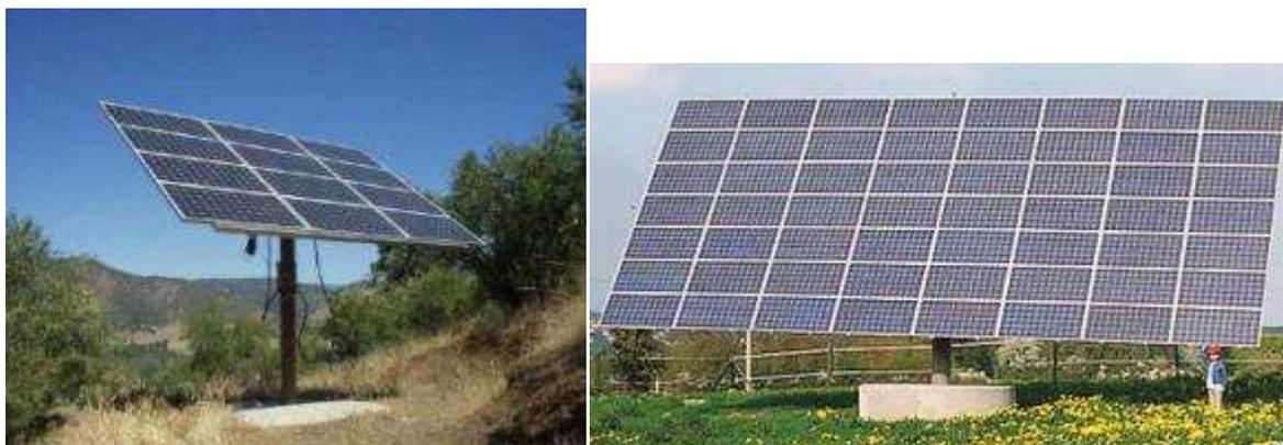
**Figure 33 : Tracker 1 axe (à gauche) et 2 axes (à droite)**
