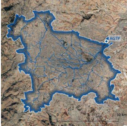
الشكل 2: منطقة تجميع مياه الصرف الصحي في محطة معالجة عين غزال، بما في ذلك خطوط الصرف الصحي الرئيسية
