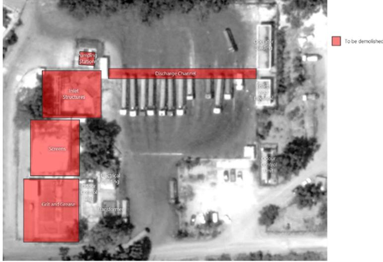
الشكل 10: المكونات التي سيتم هدمها لإيقاف تشغيل محطة تفريغ صهاريج مياه الصرف الصحي
