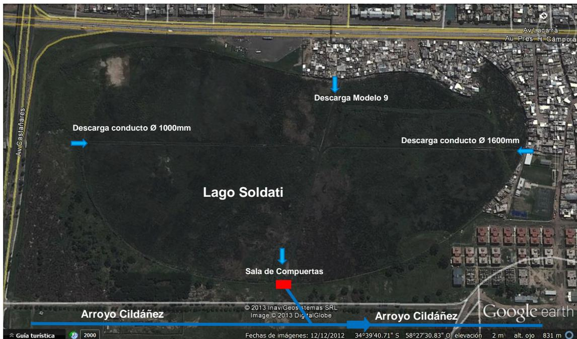
Figura 10. Conductos de descarga pluvial al Lago Soldati.
