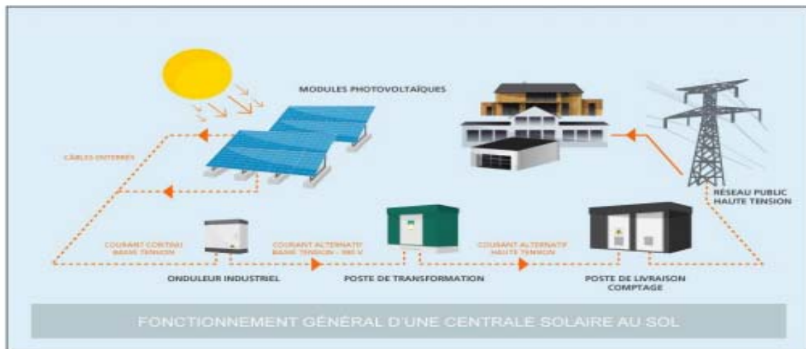
Figure 4: Principe de fonctionnement d'une installation photovoltaïque (Source : projet de construction de la centrale photovoltaïque de BOKHOL, pays : SENEGAL, code SAP : P-SN-FF0-001, département : OPSD)
