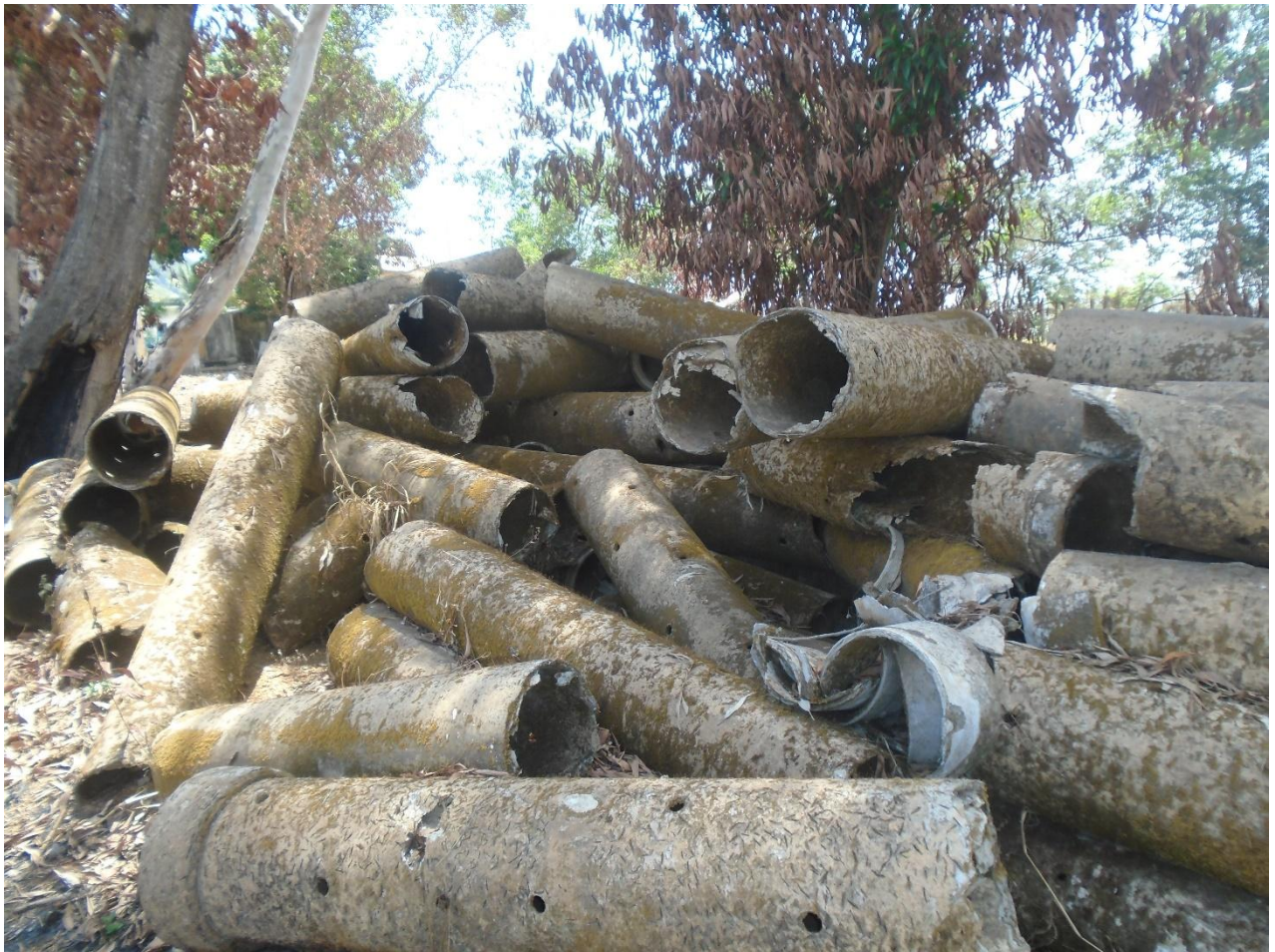
Figure 23 Ancien tuyaux en amiante -ciment stockés au centre de traitement d'eau de Yessoulou
