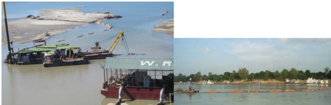
ပုံ(၄) ရေပေါ်ပေါ်နိုင်သောပိုက်များနှင့် Cutter Suction Dredger
