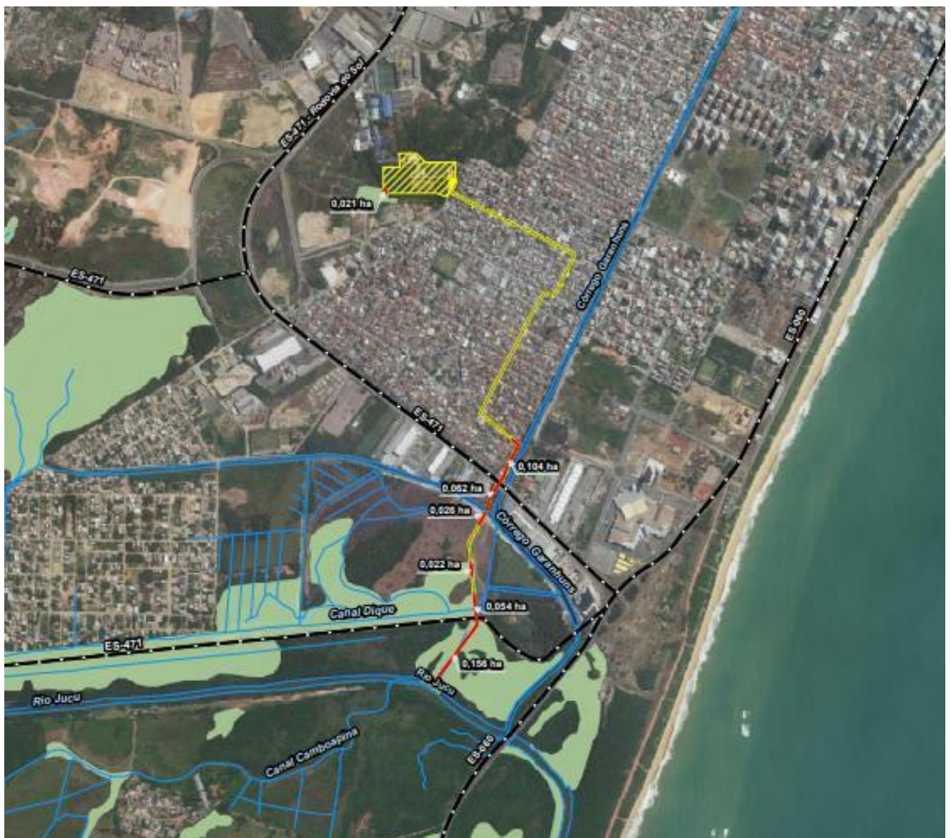
Figura 61: Emissário de efluente tratado (existente).
