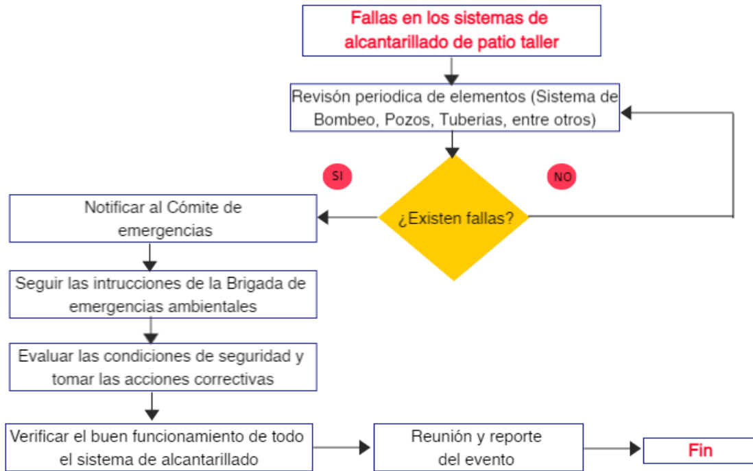
Figura 70. Procedimiento operativo para fallas en los sistemas de alcantarillado de patio taller Fuente: UT MOVIUS, 2022
