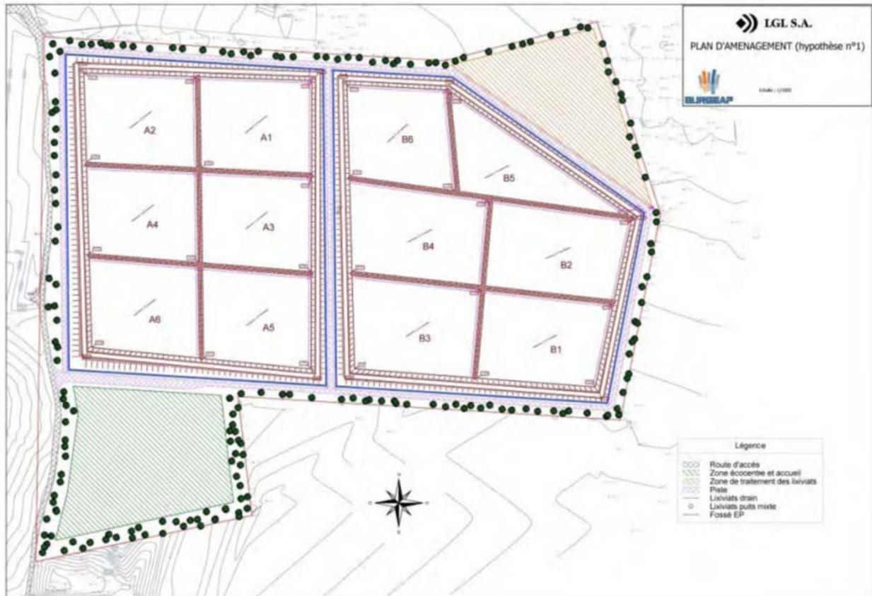
En ce qui concerne l'étanchéité du site, un géosynthétique bentonitique sera posé sous le dispositif d'étanchéité générale qui apportera une garantie d'étanchéité complémentaire. En complément à cette barrière passive, une barrière active est prévue en fond et en flancs des casiers afin d'assurer leur indépendance hydraulique, le drainage et la collecte des lixiviats.
