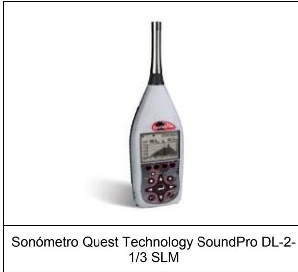
El sonómetro proporciona una medida del nivel acústico de las ondas sonoras que inciden sobre un micrófono. El nivel del sonido se visualiza normalmente sobre una escala graduada con un indicador digital.
