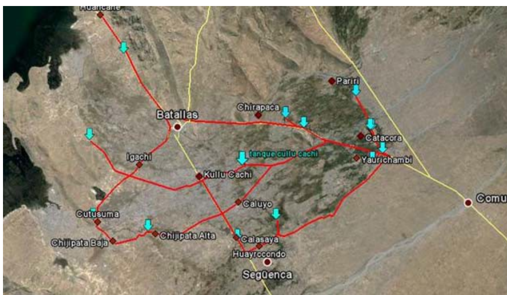
Figura 2.3-2 Alternativas de red cerrada de aducción - comunidades del Municipio de Batallas
