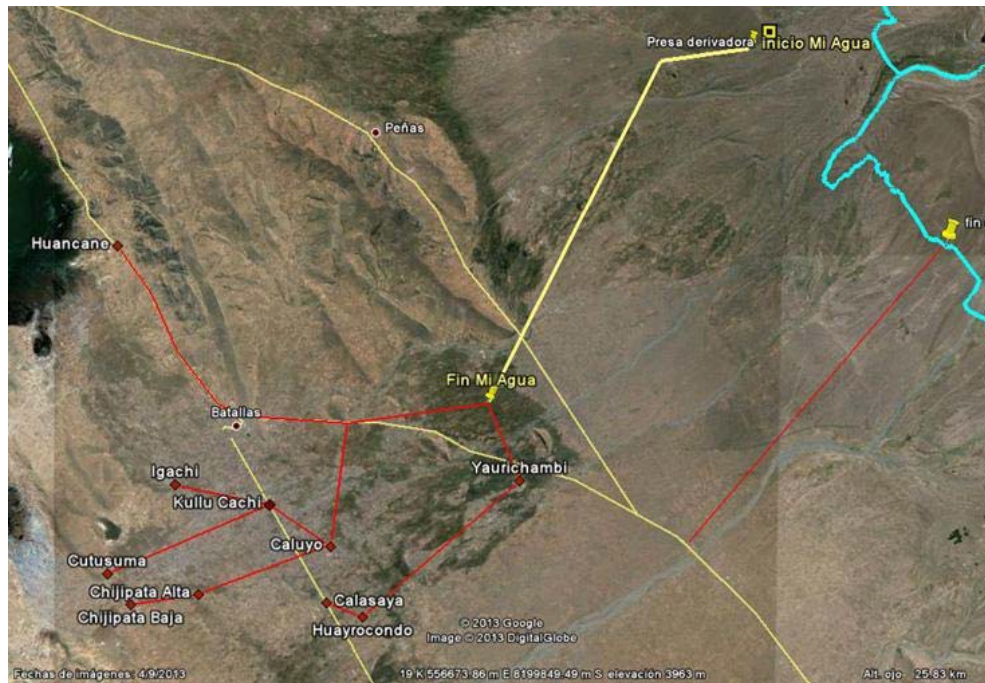
Figura 2.3-1 Red abierta de aducción a las comunidades del Municipio de Batallas
