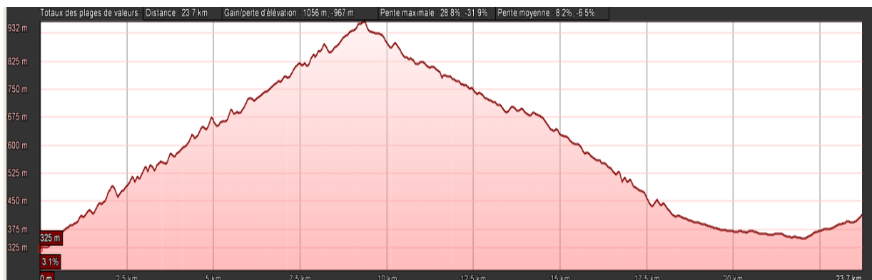
Figure 4-2 Profil longitudinal de la route RN-1 – Tronçon Ennery - Plaisance
