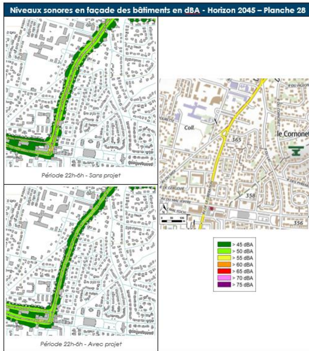
Figure 41 : Carte de bruit sur la période nocturne sur l'avenue de la Libération à Cournon d'Auvergne issu de l'étude acoustique en annexe
