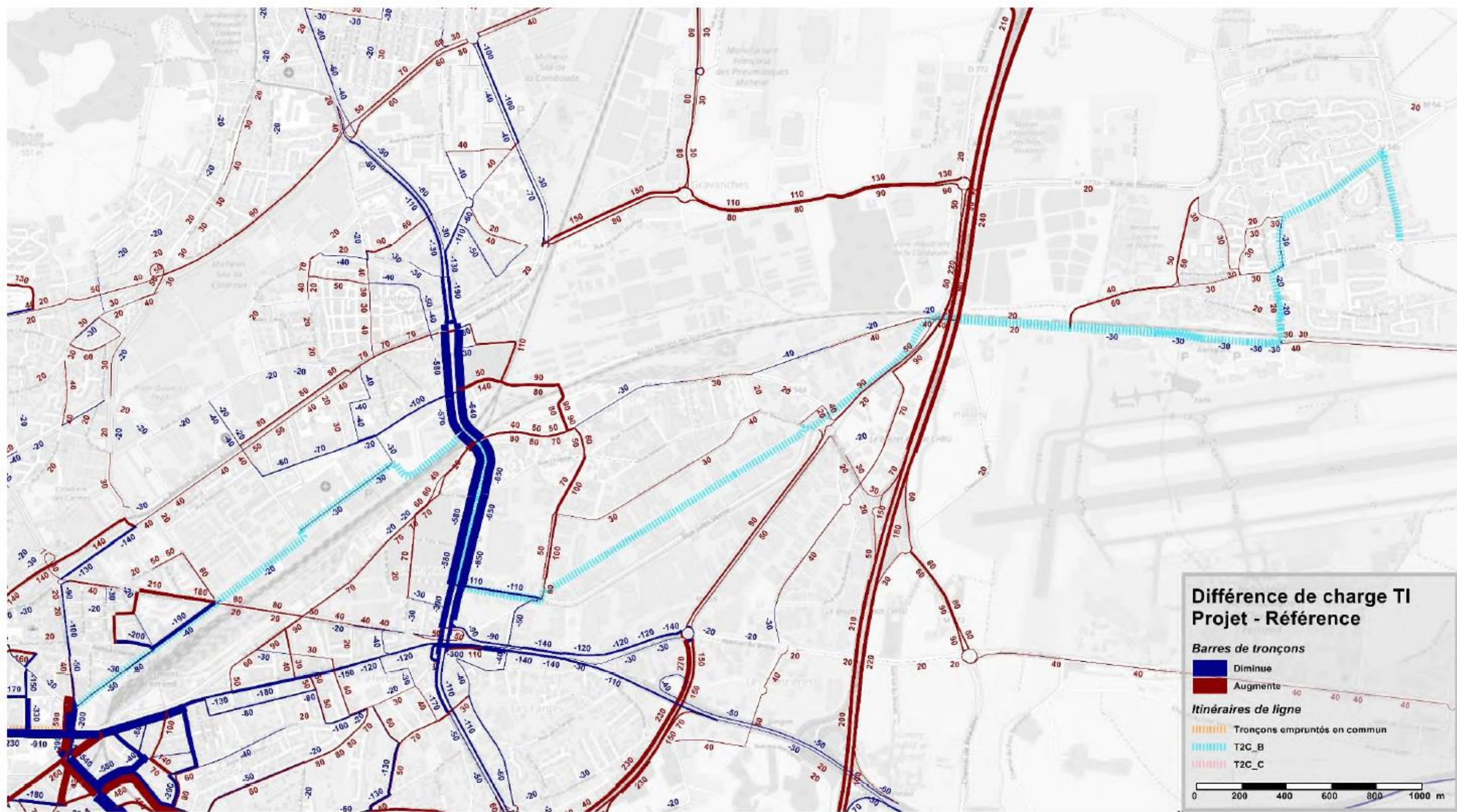
Figure 75 : Évolution de la charge de trafic entre la situation de projet et la situation de référence dans les secteurs de la gare, du Brezet et d'Aulnat – HPS
