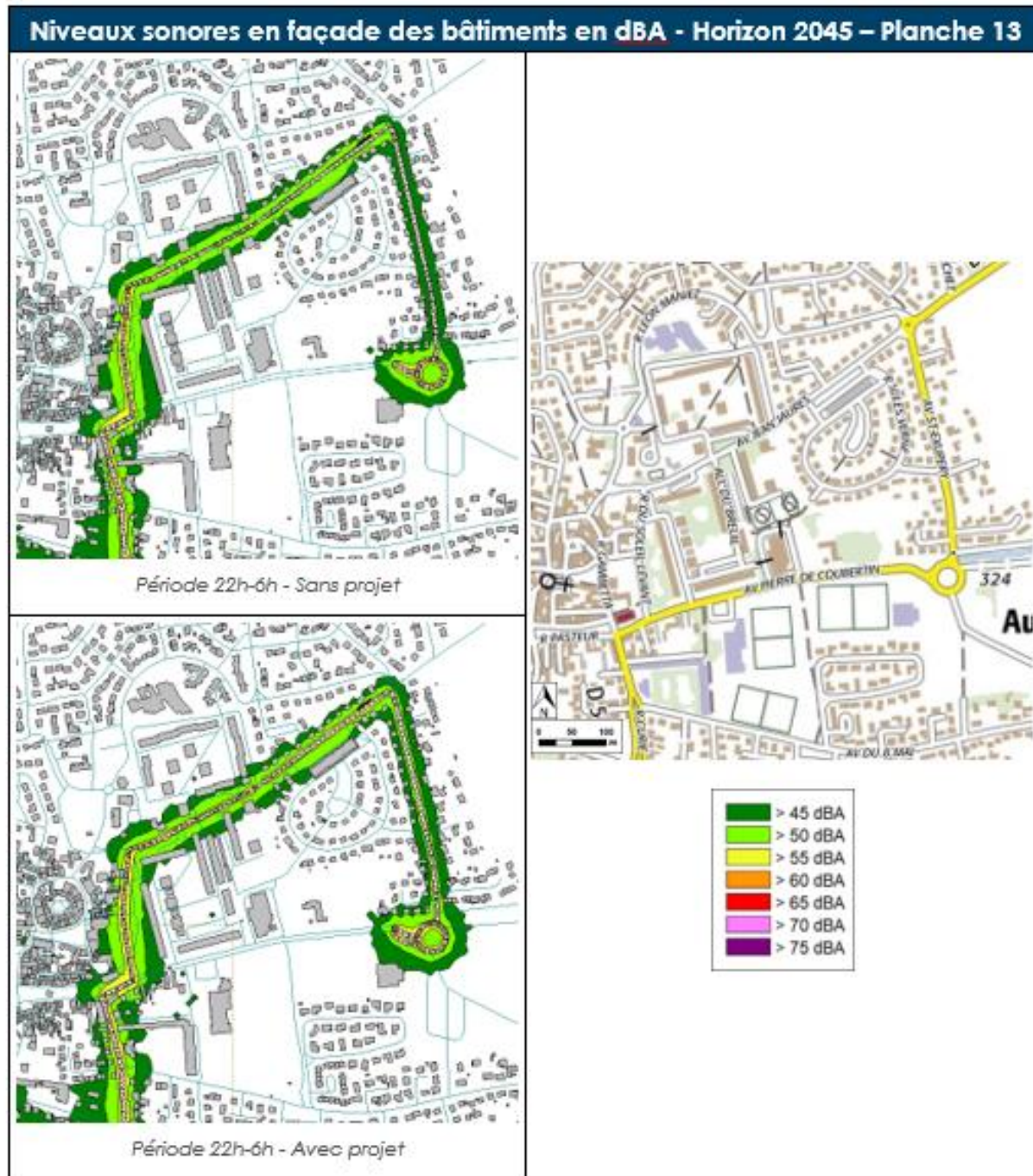
Figure 35 : Carte de bruit sur la période nocturne sur la commune d'Aulnat issu de l'étude acoustique en annexe
