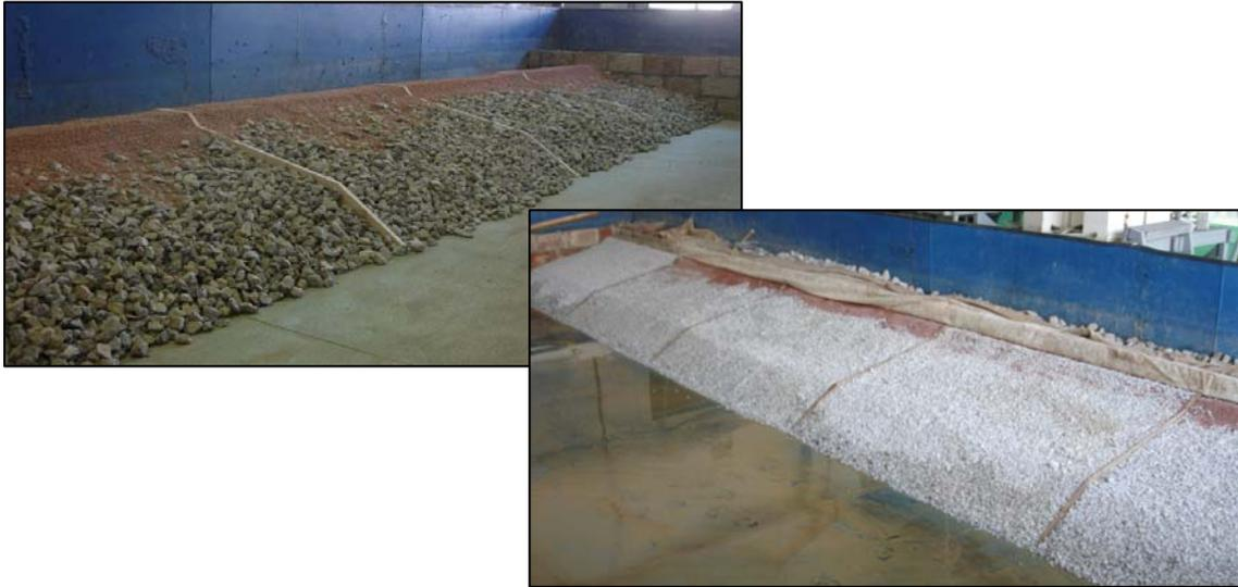
**FIGURA 5. CONSTRUCCIÓN DEL NÚCLEO. ARRIBA IZQUIERDA: MATERIAL NO SELECCIONADO DE MAYOR TAMAÑO. BAJO DERECHA: MATERIAL DE MENOR TAMAÑO.**
