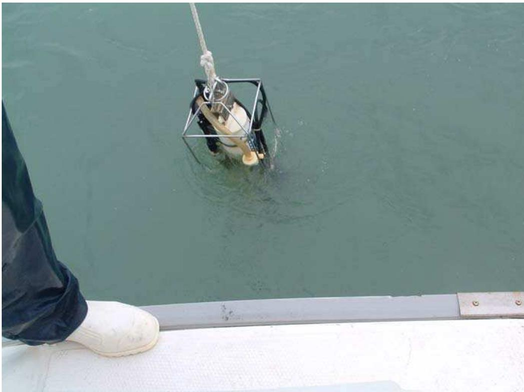
Figura. Fotografía de la sonda CTD19 entrando en el agua.
