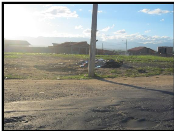
**Foto 1:** Km 186+000- Presença de resíduos Classe II B (Não inertes) dentro da faixa de domínio do DER.
