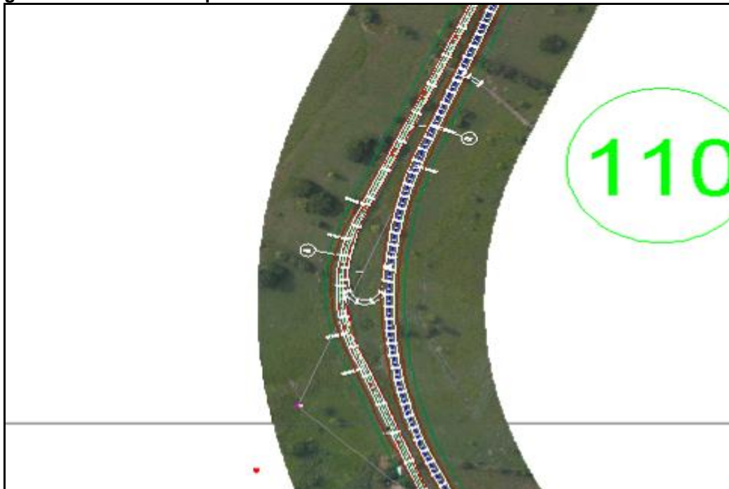
Figura 2-25 Sobreancho por retorno N-N al sur de Vasconia PR 109+600 al PR 110+460
