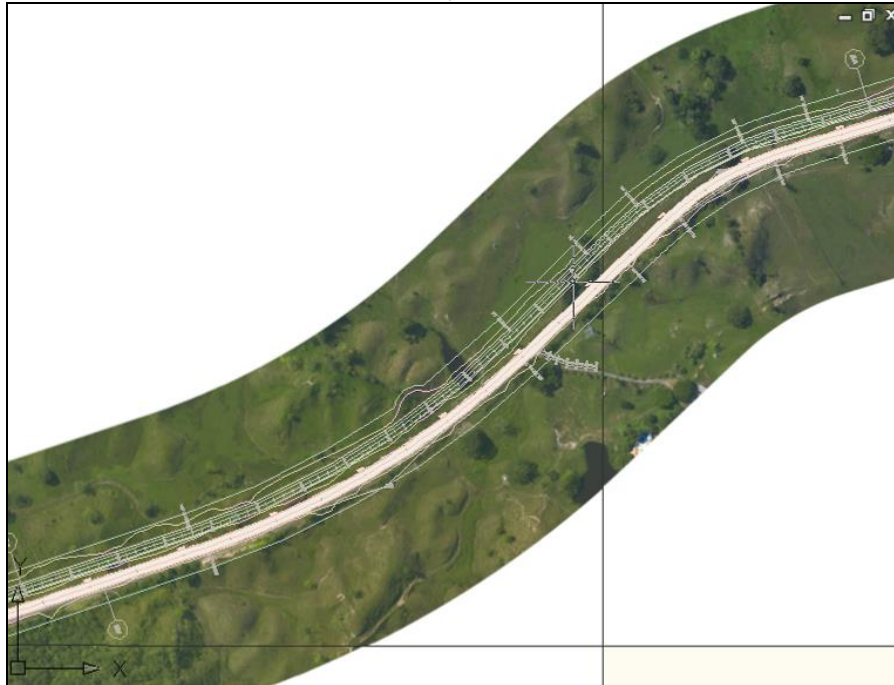
Figura 2-44 Sobrancho por diseño geométrico, PR 47+200 PR 47+850. Ancho máximo del separador 17,5m
