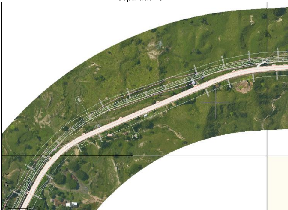
Figura 2-47 Sobrecancho por diseño geométrico, PR52+993 al PR53+400, Ancho máximo del separador 31m
