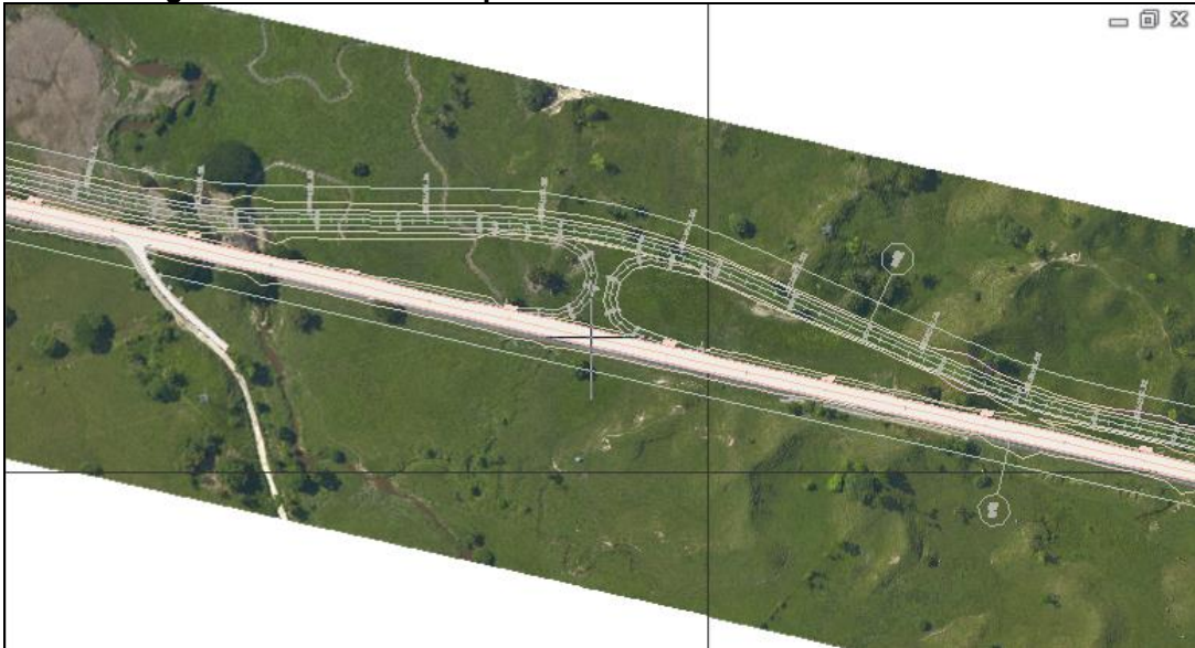
Figura 2-46 Sobrecancho por retorno doble. PR50+450 al PR51+130
