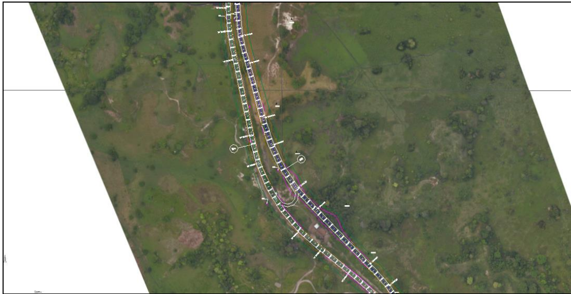
Figura 2-12 Sobreancho por retorno N-N al Sur del centro poblado El Trique PR84+200 al PR85+200 Incluye realineamiento de la vía existente
