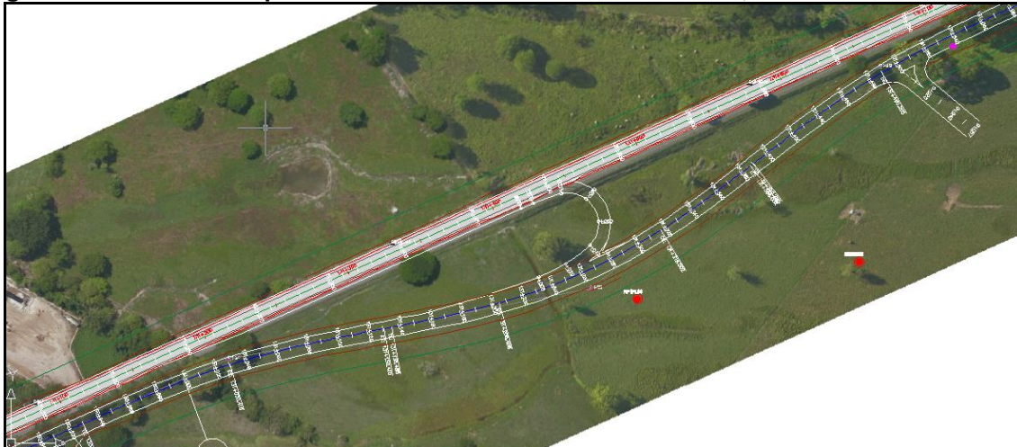
Figura 2-33 Sobreebancho por retorno S-S al norte de Puerto Serviez, PR131+100 al PR131+730
