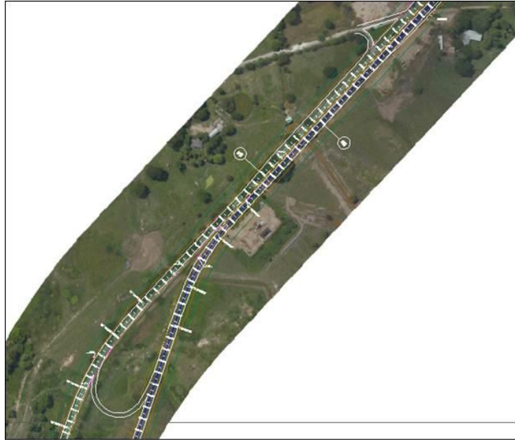
Figura 2-32 Sobreebancho por retorno N-N al sur del acceso a Puerto Serviez. PR129+000 al 130+000
