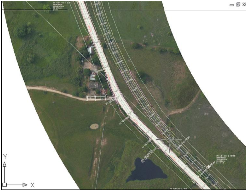
Figura 2-25 Sobreancho por retorno N-N al sur de Vasconia PR 109+600 al PR 110+460
