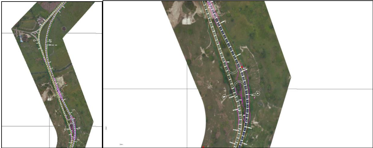
Figura 2-17 Sobrecancho por diseño geométrico del PR 96+310 al PR 97+180, Ancho máximo del separador 72 m
