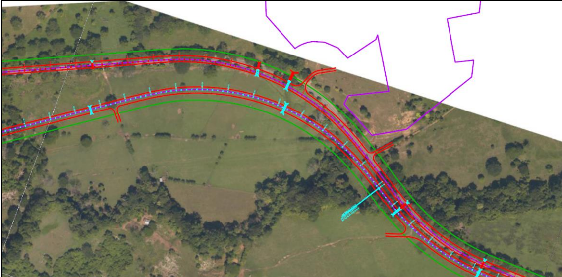
Figura 2-98 Realineamiento de calzada PR13+300 a PR13+715
