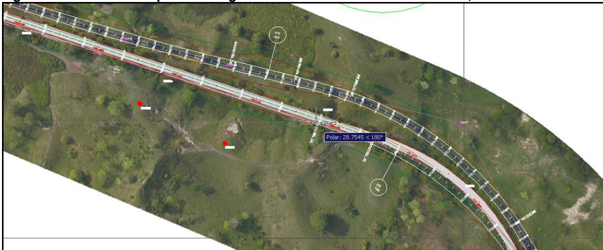
Figura 2-23 Sobreancho por diseño geométrico PR 107+720 a PR 108+390, Ancho máximo 28 m
