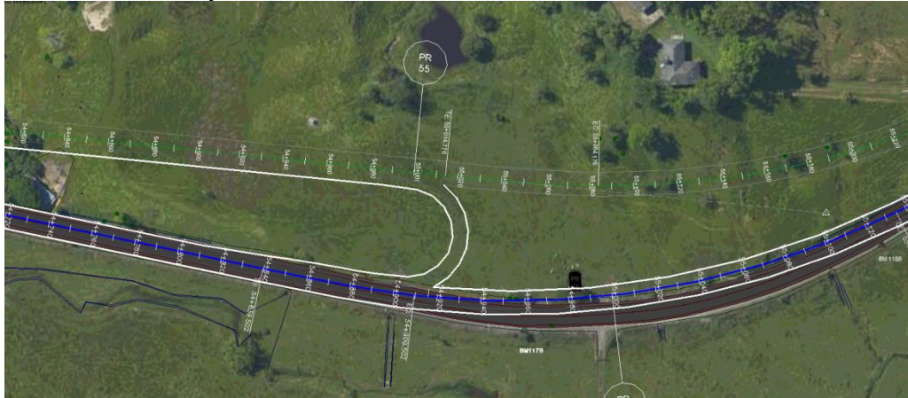
Figura 2-49 Sobreancho por diseño geométrico, PR58+050 al PR58+200, Ancho máximo del separador 19m
