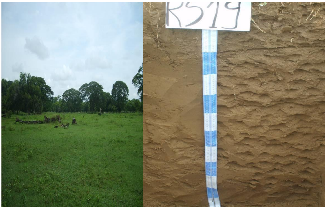
Fotografía 3-19 Perfil modal RS-19 Fluventic Hapludolls (PVJ), familia franco fina, isohipertérmica - Asociación Sueño (PVK)
