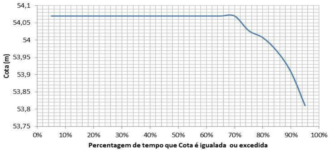
Figura 40 Curva de Permanência da Lagoa Cerâmica com a soleira alterada para 55,0 m.
