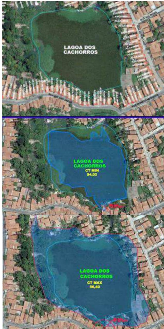
Figura 24- SITUAÇÃO DE CADASTRO E NÍVEIS MÁXIMO E MÍNIMO DA LAGOA DOS CACHORROS, APÓS A INTERVENÇÃO.
