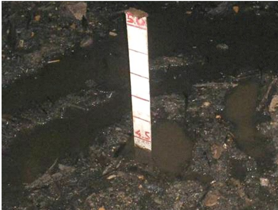
Foto 1: Régua localizada no canteiro de obras da Construtora Andrade Gutierrez à margem direita do Rio Guamá – nível do Rio Guamá: em ascensão - 23:46h do dia 20/03/2007.
