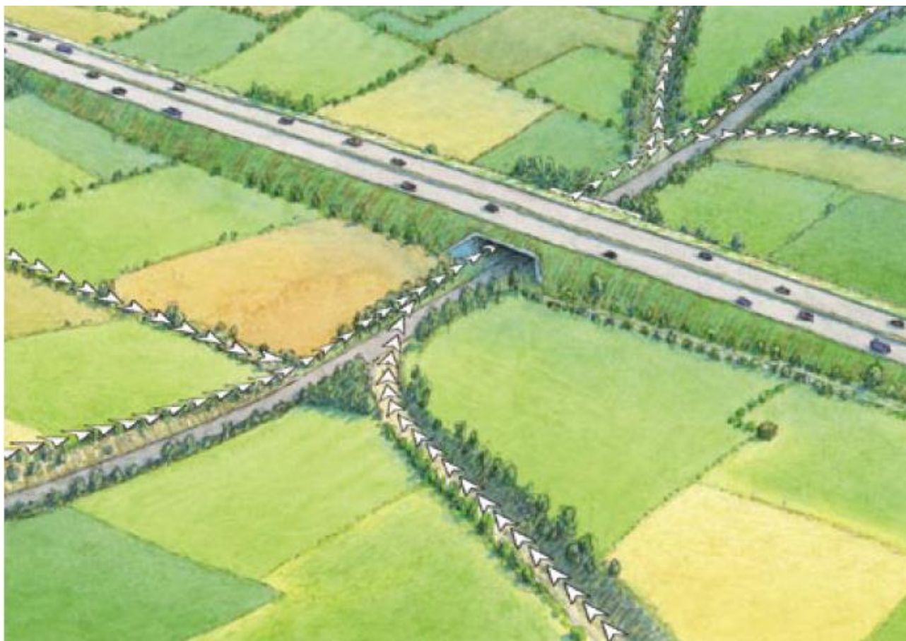
Rysunek 76 Schemat przelotu nietoperzy pod drogą z wykorzystaniem obiektu mostowego/drogowego (Bats and roads, Ministerie van Verkeer en Waterstaat, 2005)
