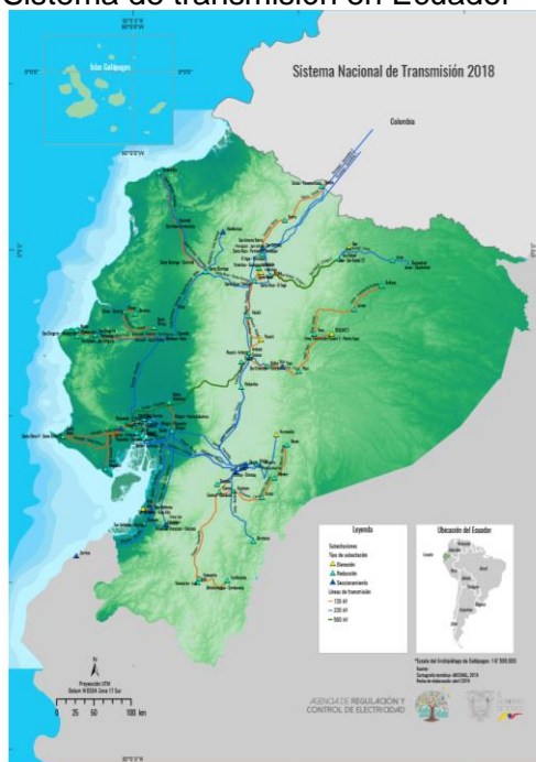
Figura No. 2-15: Principales instalaciones del SNT al 2018.
