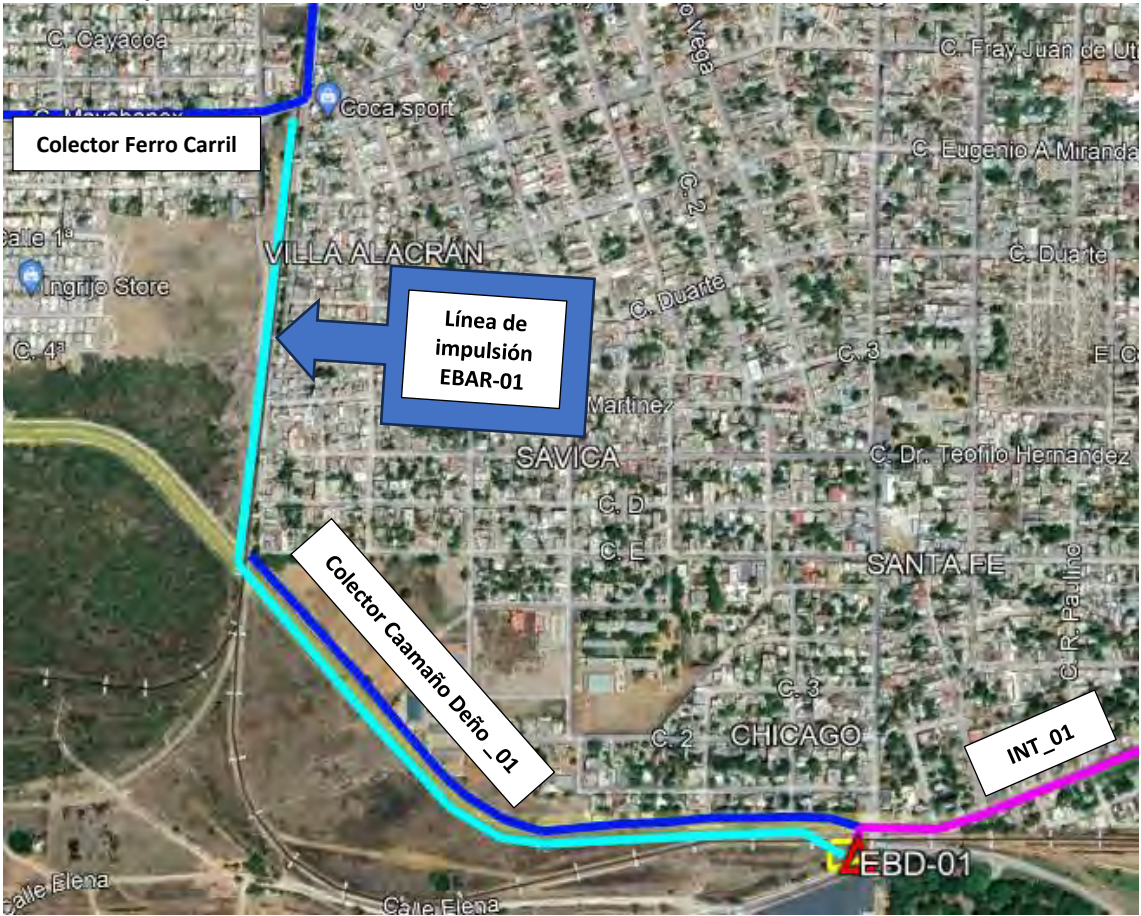
Figura 4.3.1.e Línea de impulsión de la EBAR-01
