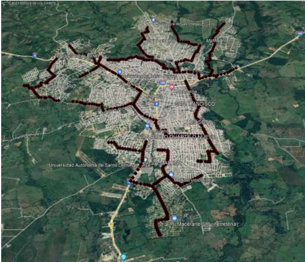
Imagen No. 24. Nodos de colectores maestros para el sistema alcantarillado sanitario propuesto
