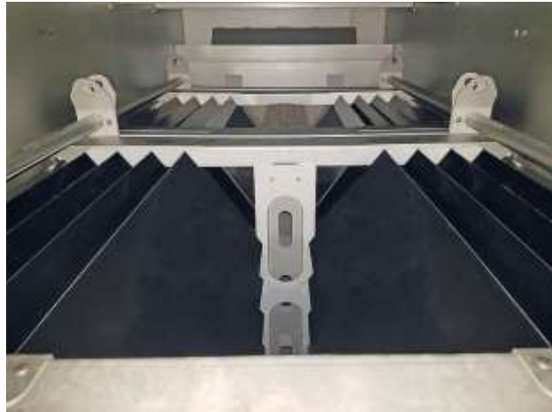
Imagen No. 8. Desarenador Lamelar, de fabricante Huber Fuente.: (Dieter Neder, 2024)
