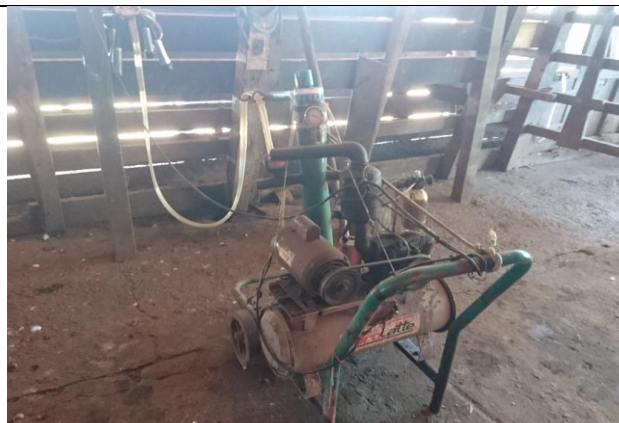
Fig. 74: Sala de ordeño improvisada con un brete de sujeción y con una máquina de ordeño móvil de un solo órgano. ¡¡¡¡No chequeada!!!!
