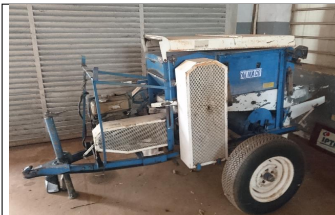
Fig. 8: Trilladora estacionaria. Marca Almaco. Para distintos cultivos y granos.
