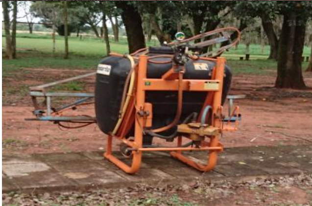
Fig. 5: Pulverizadora Jacto, Modelo Condorito, de 400 lts. Con barras de aplicación. En Buen estado operativa para aplicaciones sobre las parcelas. Disponen de 2 más.
