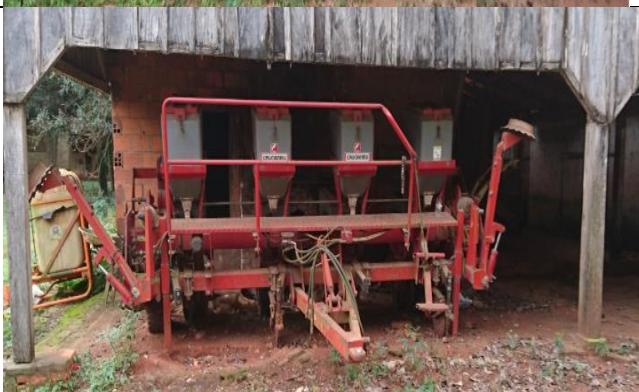
Fig. 11: Sembradora de grano grueso, marca Crucianelli.
