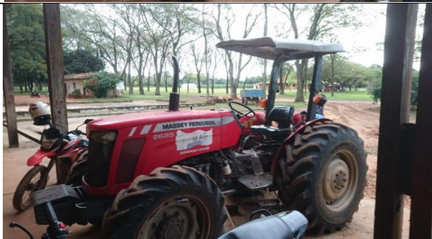
Fig. 7: Tractor de 50 a 80 HP. Carente de estructura de seguridad, sin cabina cerrada.
