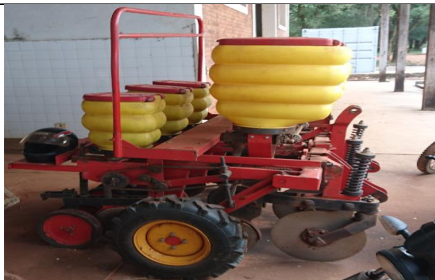
Fig. 6: Sembradora de placa de 3 surcos, Horizontal, Buen estado
