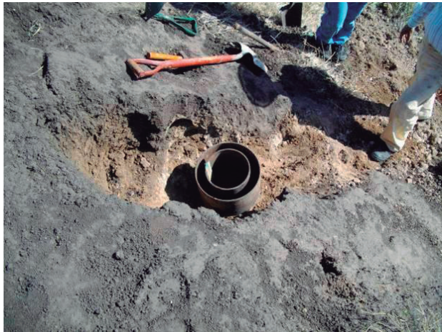
Foto 13 y Fig. 6. Ensayo de infiltración in situ sobre Horizonte C.
