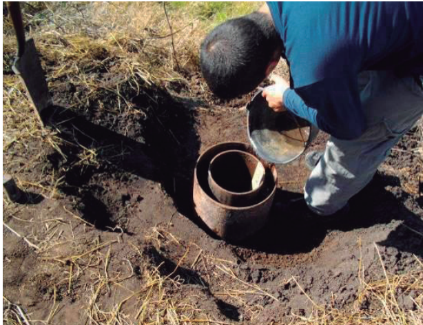
Foto 12, Fig. 5. Ensayo de infiltración in situ sobre horizonte B
