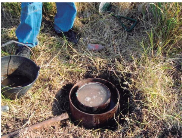
Foto 14 y Fig. 7. Infiltración in situ sobre terrenos Pampianos
