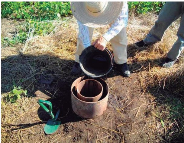
Foto 11 y Fig. 4 Ensayo de infiltración in situ sobre Horizonte A
