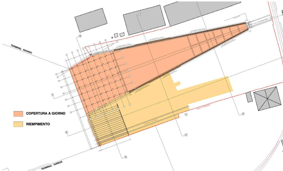
**Figura 6-29 – Planimetria di progetto con distinzione dell'area di banchinaggio**
