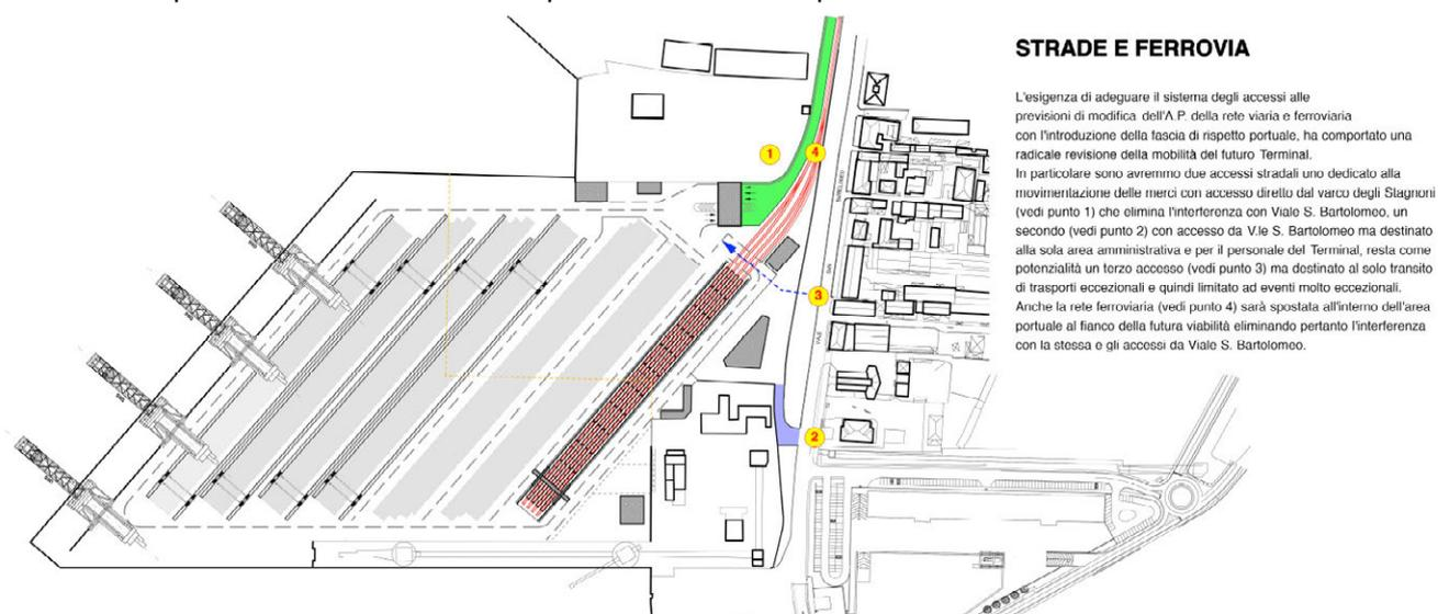
**Figura 6-41 – Viabilità interna e linea ferroviaria - planimetria**
