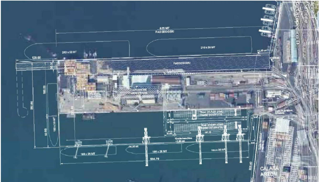
**Figura 6-26 – Ampliamento a mare Molo Garibaldi: planimetria di progetto su fotopiano (vista ruotata)**
