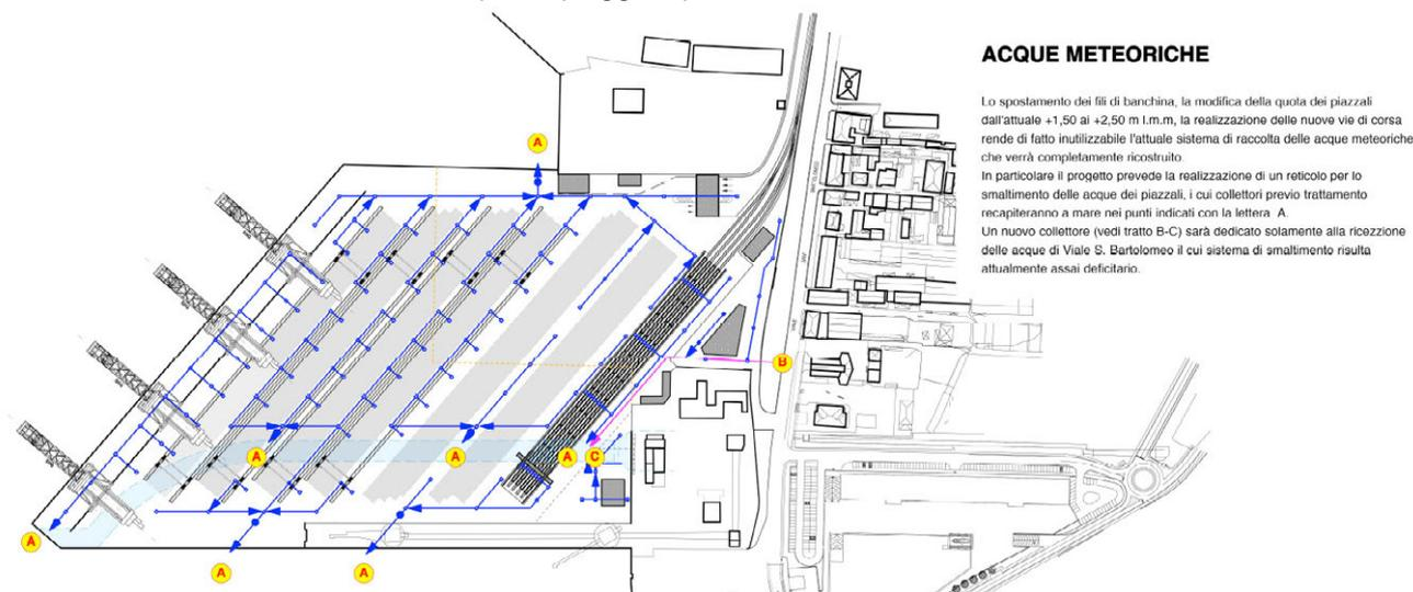
Figura 6-42 – Rete di raccolta delle acque meteoriche - planimetria
