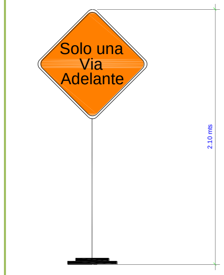
SEÑAL VERTICAL EN ZONAS DE TRABAJO
