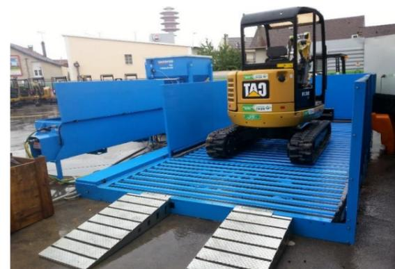
*Station de nettoyage modulaire et mobile
