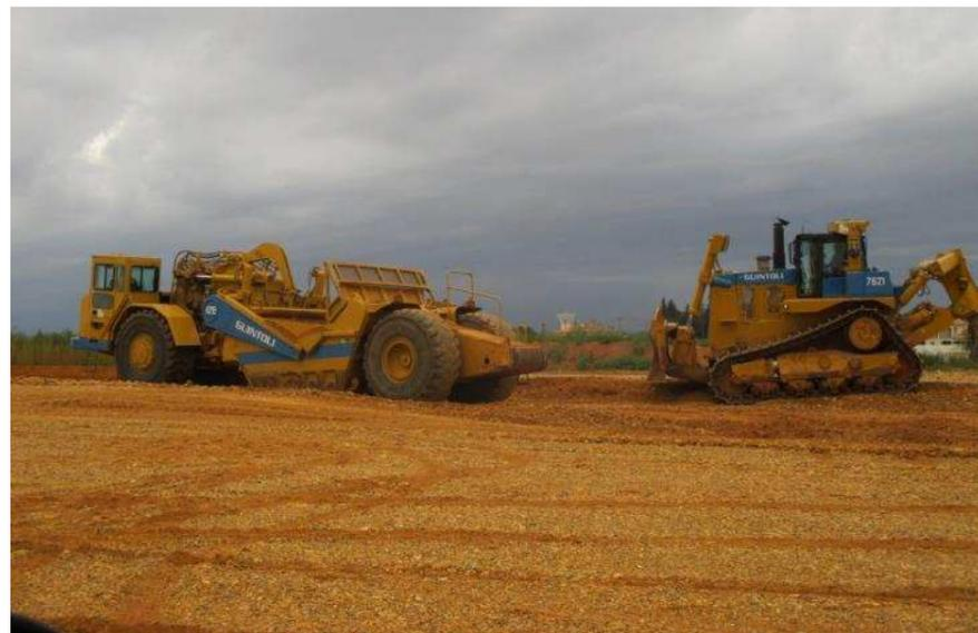
Photo 21 : Engins de chantier (source : chantier CNM, setec)
