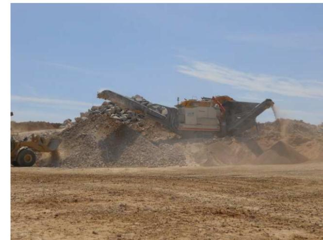
Photo 22 : Opération de criblage-concassage
